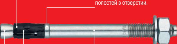
Кольцевой упор обеспечивает надежную фиксацию распорной втулки даже при наличии арматуры и нежелательных полостей в отверстии.
