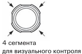
Анкер установлен правильно, если анкерная гильза установлена заподлицо с поверхностью бетона и видны 4 сегмента гильзы.
