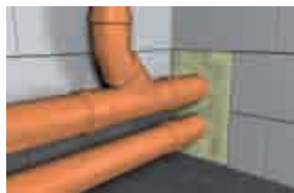
Заделка сквозных отверстий при монтаже трубопроводов
