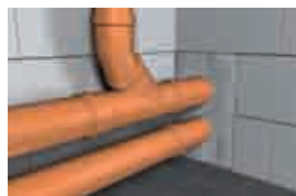
Заполнение сквозных отверстий при монтаже трубопроводов
